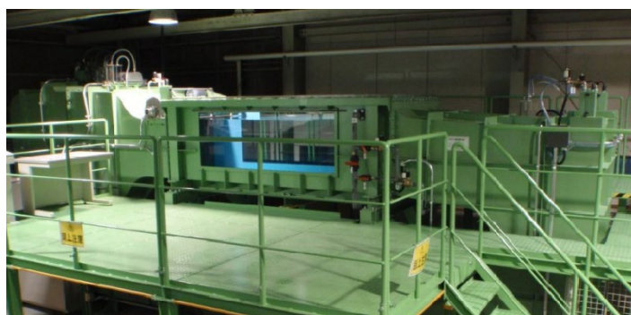
縦型回流水槽(西日本流体技研：V2-20B)
