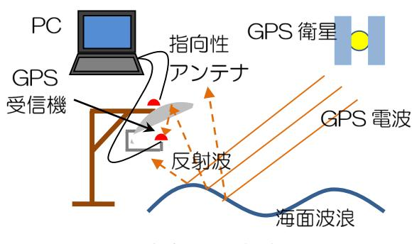
図1 波浪計測の概念図
