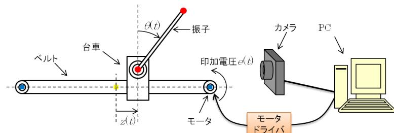
図1 ビジュアルフィードバックによる倒立振子の制御系
