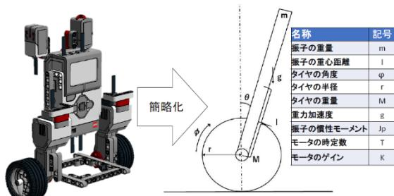
図3 【例2】で使用した倒立振子型教育用ロボット
