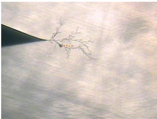
図 1 針電極近傍にボウタイトリーが存在する場合の電気トリー発生例
