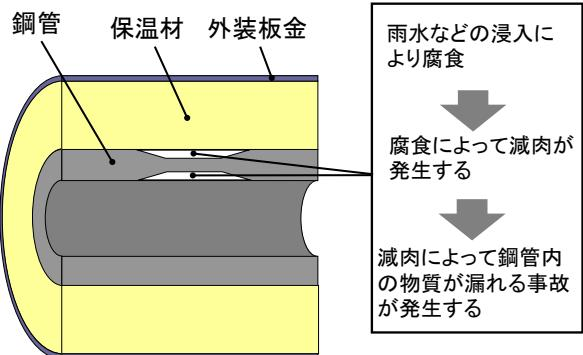
主に、石油精製プラントなどの設備で使用されている強磁性構造物(原油タンク、配管など)に発生する経年劣化などを検査対象としている。
