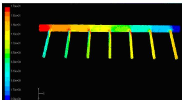
図3 吹出しダクト系の風速分布
