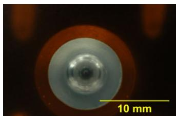
図 3 密閉ボイド内での部分放電発光観察例
