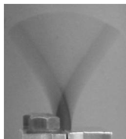
図2 磁性エラストマ製はりの振動
