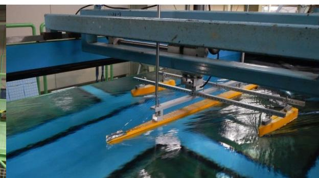
回流水槽での船体抵抗試験
