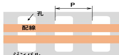
図4 孔あけによる誘導電流低減構造
