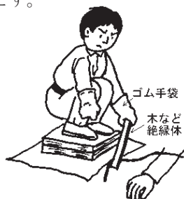
絶縁体を使って原因となる電源や電気製品を離す。
