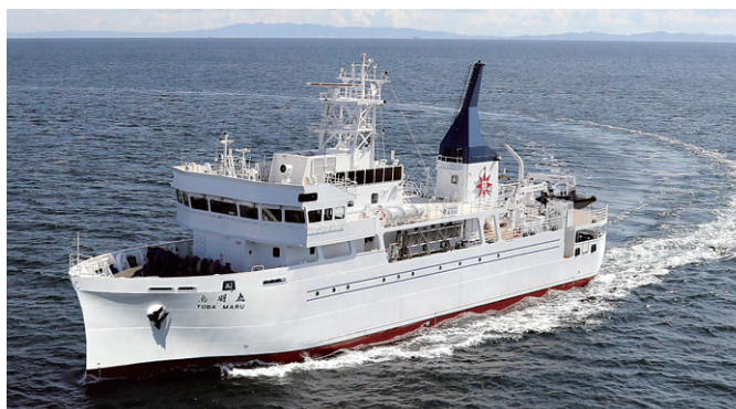
図1【鳥羽丸：全長56.3m・幅10.6m・喫水3.4m・総トン数397トン・航海速度12.5ノット】
