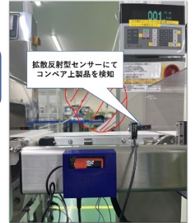
図2 PBLで製作したIoT製品カウンター
