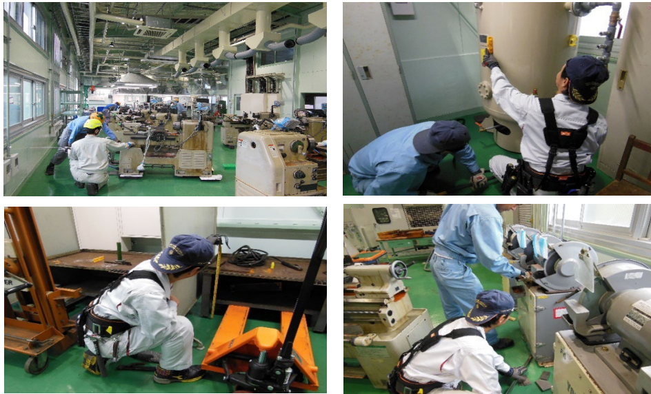
図1 工作機械等のレベル出し
