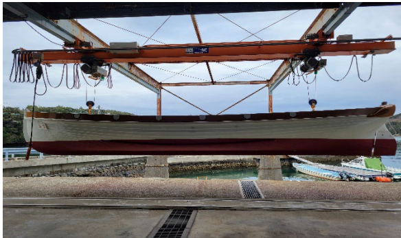
図4 船底の清掃及び舟艇塗料を行った端艇
