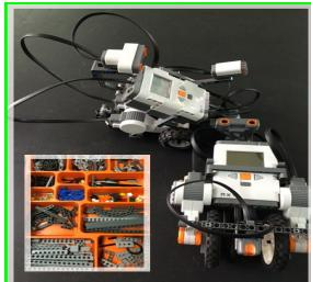
LEGOロボットを作成し、少し高度な機械の動きについて勉強します。重要な歯車、軸、車輪などの機械要素を学んだうえで、設計書に基づいて様々な機構を構築します。さらに、センサを用いた動作も挑戦しましょう。
