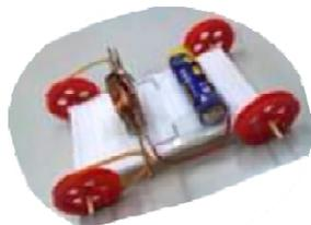
クリップモータは、磁石と被覆線で作る最もシンプルなモータです。力は弱いけれど、バランス良く作れば非常によく回ります。電磁力を学習した後、クリップモータを作って動かしてみます。上手くいったら、小さな車を走らせることにチャレンジしよう。
