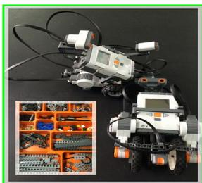
LEGOロボットを作成し、制御プログラムについて勉強します。様々なセンサから得られるデータに基づいて、動作を変更するライトレースロボットを製作しましょう。
