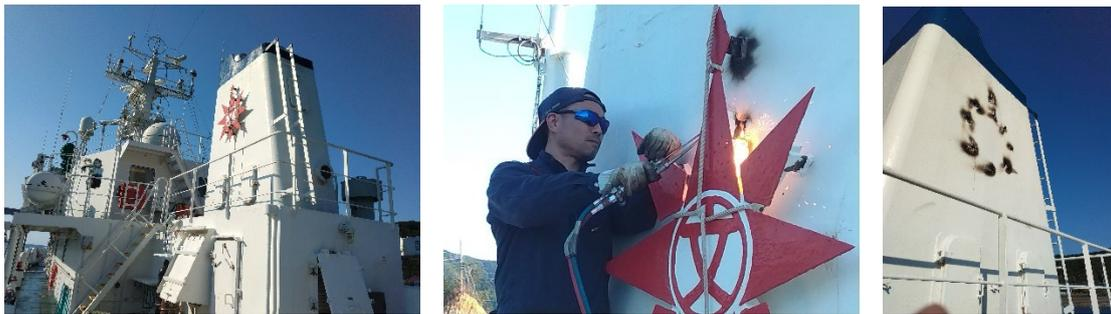
図1 校章溶断の様子
