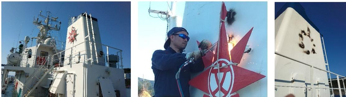
図1 校章溶断の様子
