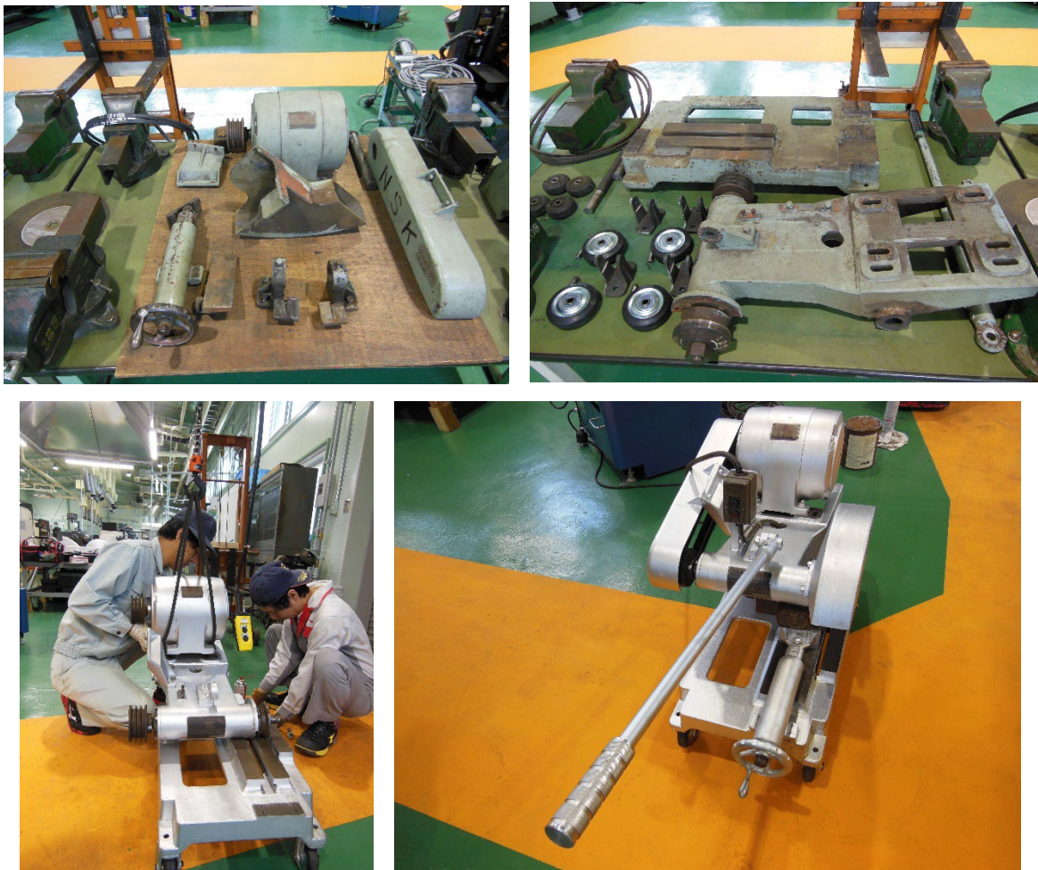
図3 高速カッター整備
