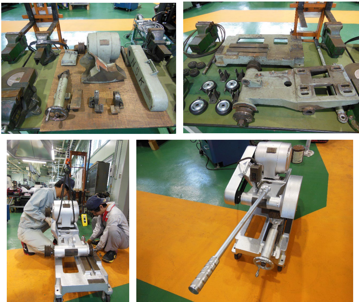
図3 高速カッター整備
