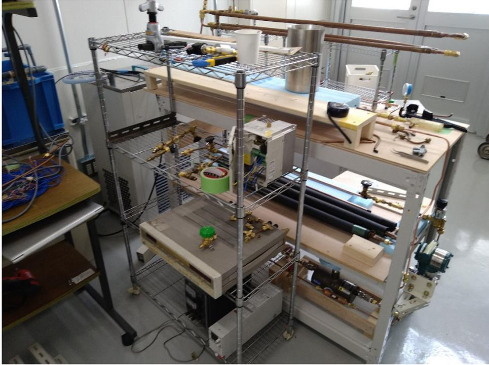
実習工場 B 棟多目的室に製作中の伝熱試験用冷凍機
