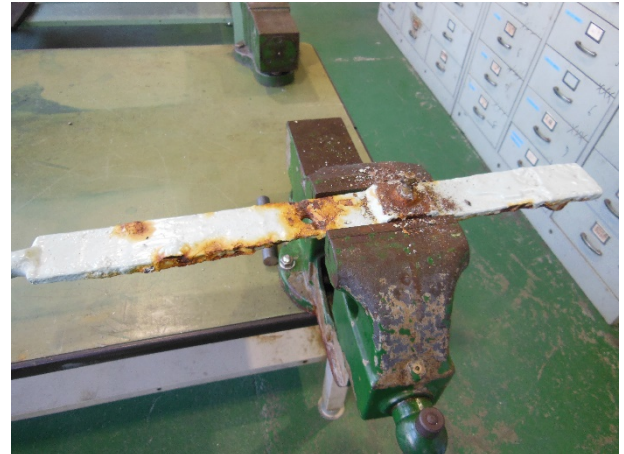
図2 クラッチハンドル修理
