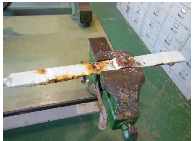
図2 クラッチハンドル修理
