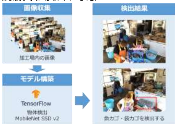
図 4 加工作業識別 AI の構築の流れ
