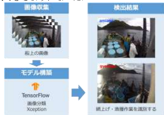
図2 船上作業識別 AI の構築の流れ
