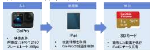
図 2 観測機のシステム概要
