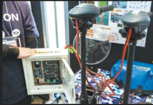
自動給餌で日本の水産業を守る。給餌機を含む独自開発のシステムにより、マダイへの24時間ピンポイント自動給餌を実現。養殖生産量の増加をサポートする。仕組みはこうだ。生け簀(いけす)をドローンが周回。マダイのいる地点を特定して入水する。
