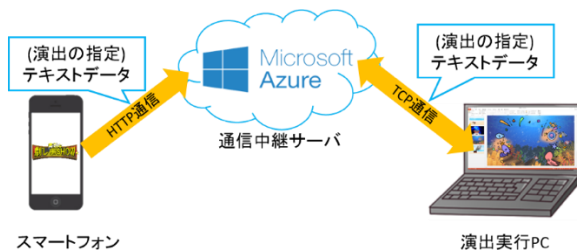
図17 スマートフォンを用いたデータの流れ
