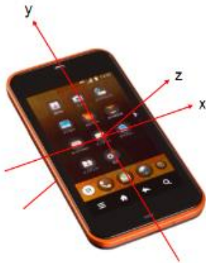
図 8 Android 端末の加速度センサの軸方向
