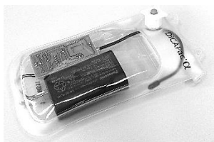
図 3 防水ケースに封入した測定装置
