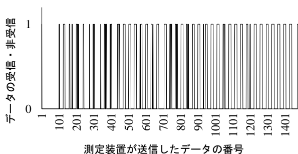
図 10 データが損失するタイミングの計測結果
