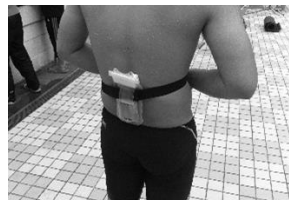
図 4 測定装置を泳者の腰部に取り付けた様子
