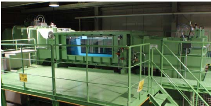
縦型回流水槽(西日本流体技研：V2-20B)
