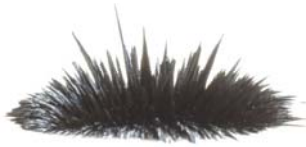
図3 磁気機能性流体の界面変形現象
