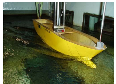
写真1 抵抗試験の様子
