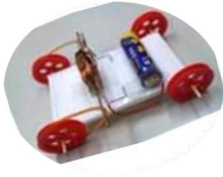
クリップモータは、磁石と被覆線で作る最もシンプルなモータです。力は弱いけれど、バランス良く作れば非常によく回ります。電磁力を学習した後、クリップモータを作って動かしてみます。上手くいったら、小さな車を走らせることにチャレンジしよう。
