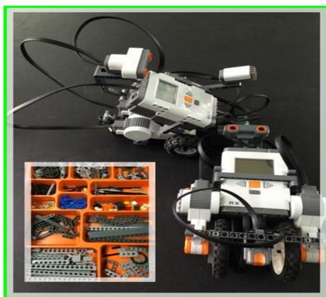
LEGOロボットを作成し、制御プログラムについて勉強します。様々なセンサから得られるデータに基づいて、動作を変更するライントレースロボットを製作しましょう。
