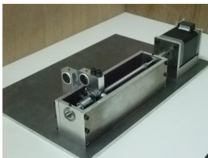
図 2：（左）マイクロフォンとスピーカで構成された音響波プローブの例、（右）音響波プローブによる、空間中の環境情報（温度）の取得結果。温度分布をはじめとする環境情報を、簡潔な構造、かつ、測定対象（空間）に対して非侵襲な方法で取得する手法について検討しています。
